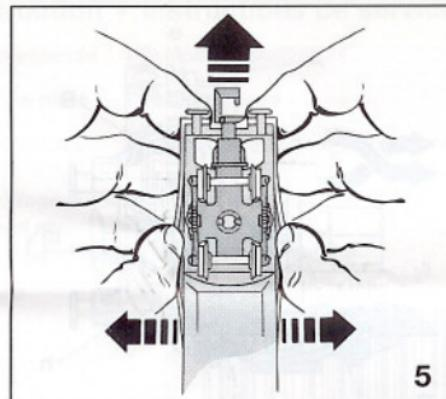
Alte Stirnfensterblende herausnehmen, neue einsetzen und an den Rastpunkten d einrasten lassen.
