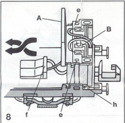
Erst Lichtabdeckung A, dann Schlußlichtplatine B auf die Zapfen e aufsetzen. Die beiden Kabel der Schlußlichtplatine B überkreuzen und in die Kontaktklemmen f einstecken.
